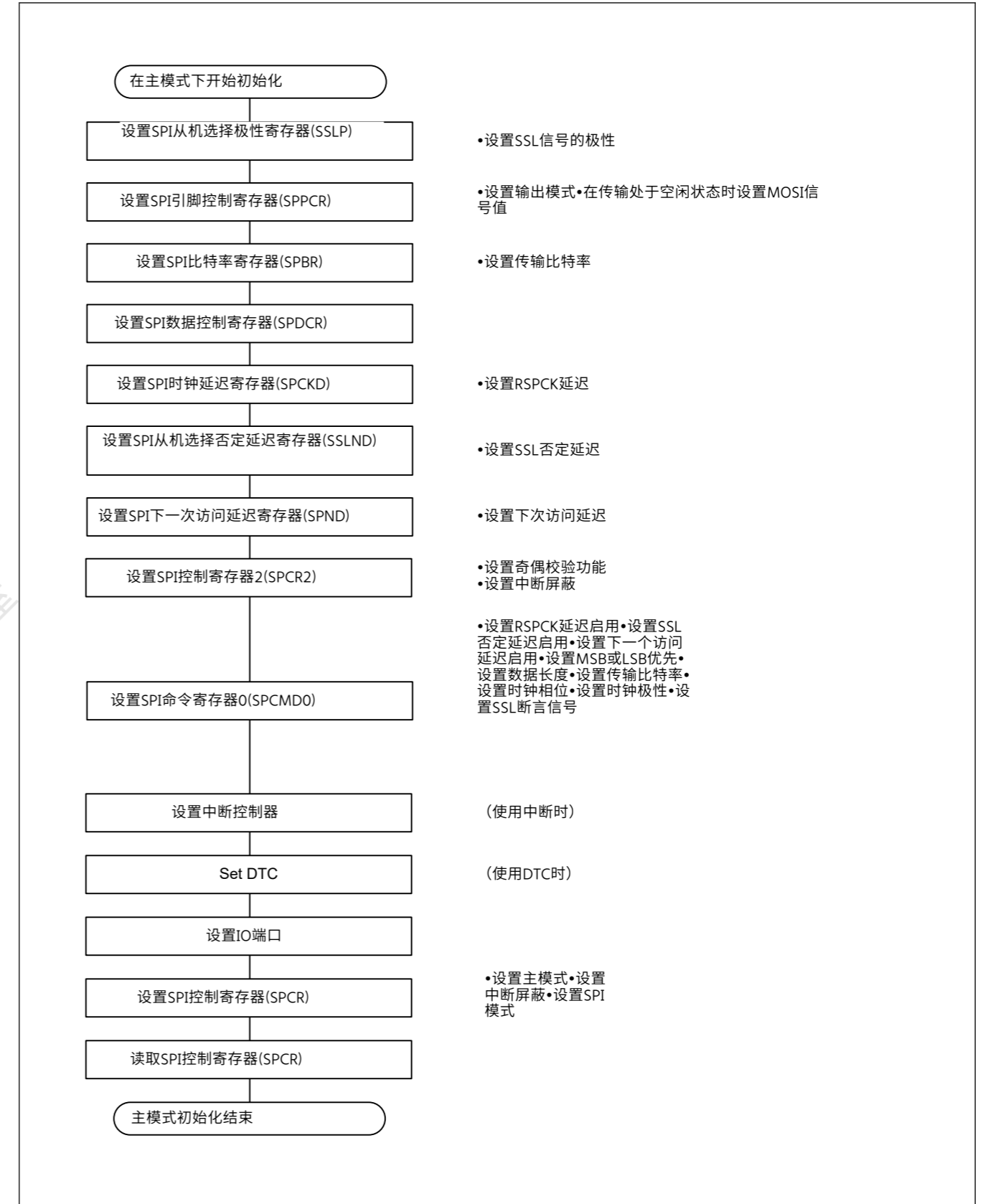
Figure 27.32 SPI操作的主模式初始化流程示例
