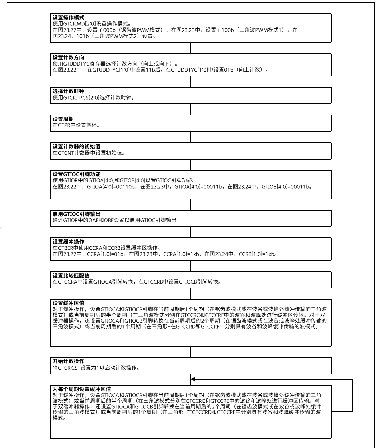
Figure 23.25 为输出比较设置GTCRA和GTCCRB缓冲操作的示例
