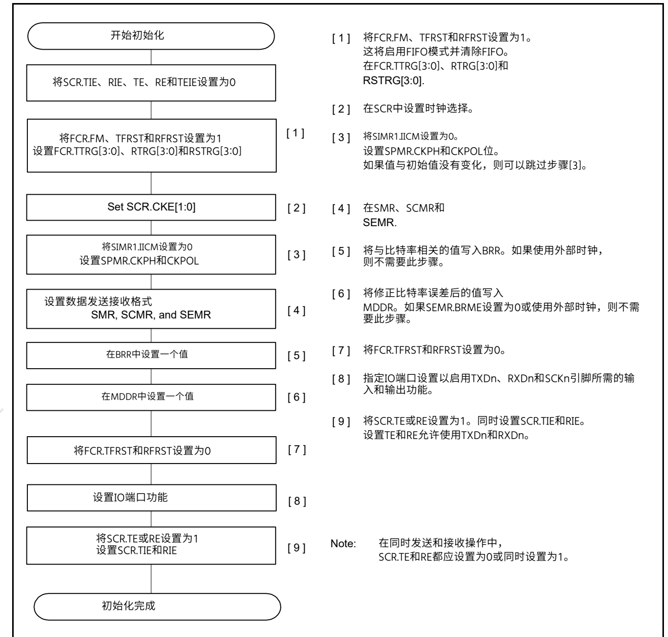
Figure 29.33 选择FIFO的时钟同步模式下的SCI初始化示例流程
