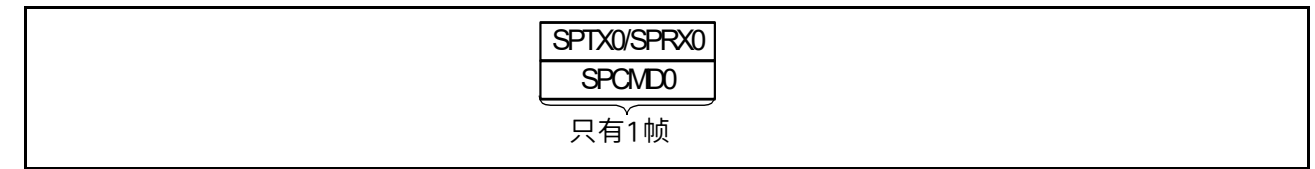
Figure 32.41 顺序操作中SPI命令寄存器与发送和接收缓冲区的关系 (SPI1)
