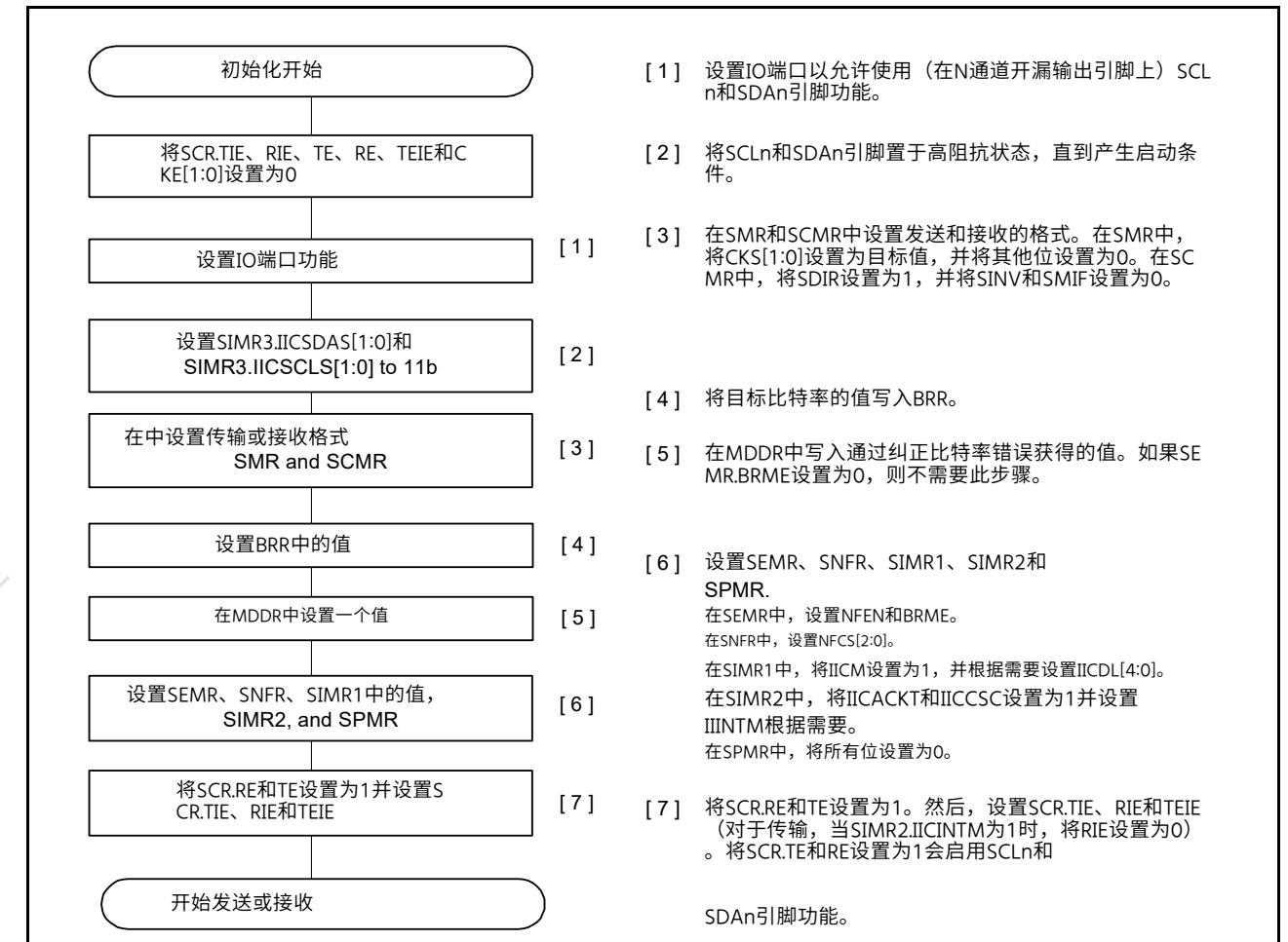
Figure 29.63 简单IIC模式下SCI初始化示例流程
