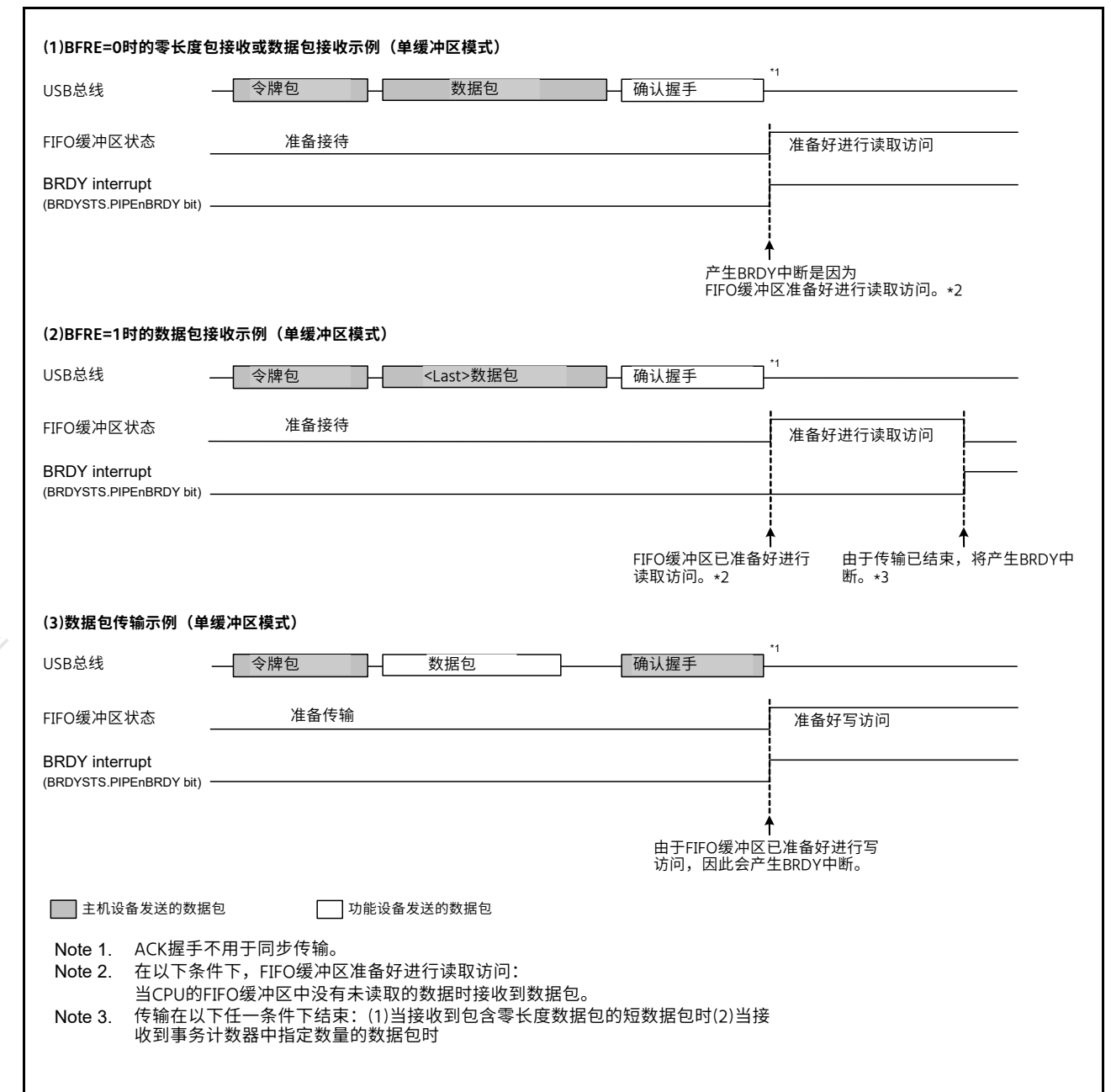
Figure 28.8 BRDY中断产生的时序
