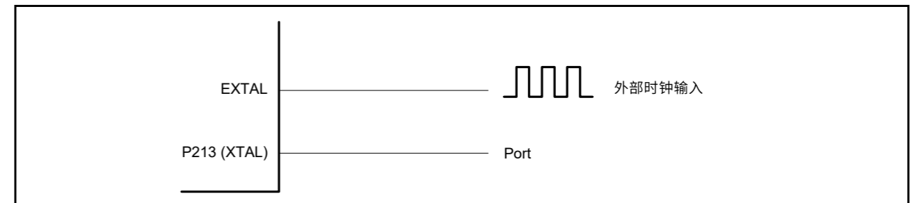
Figure 9.8 外部时钟等效电路
