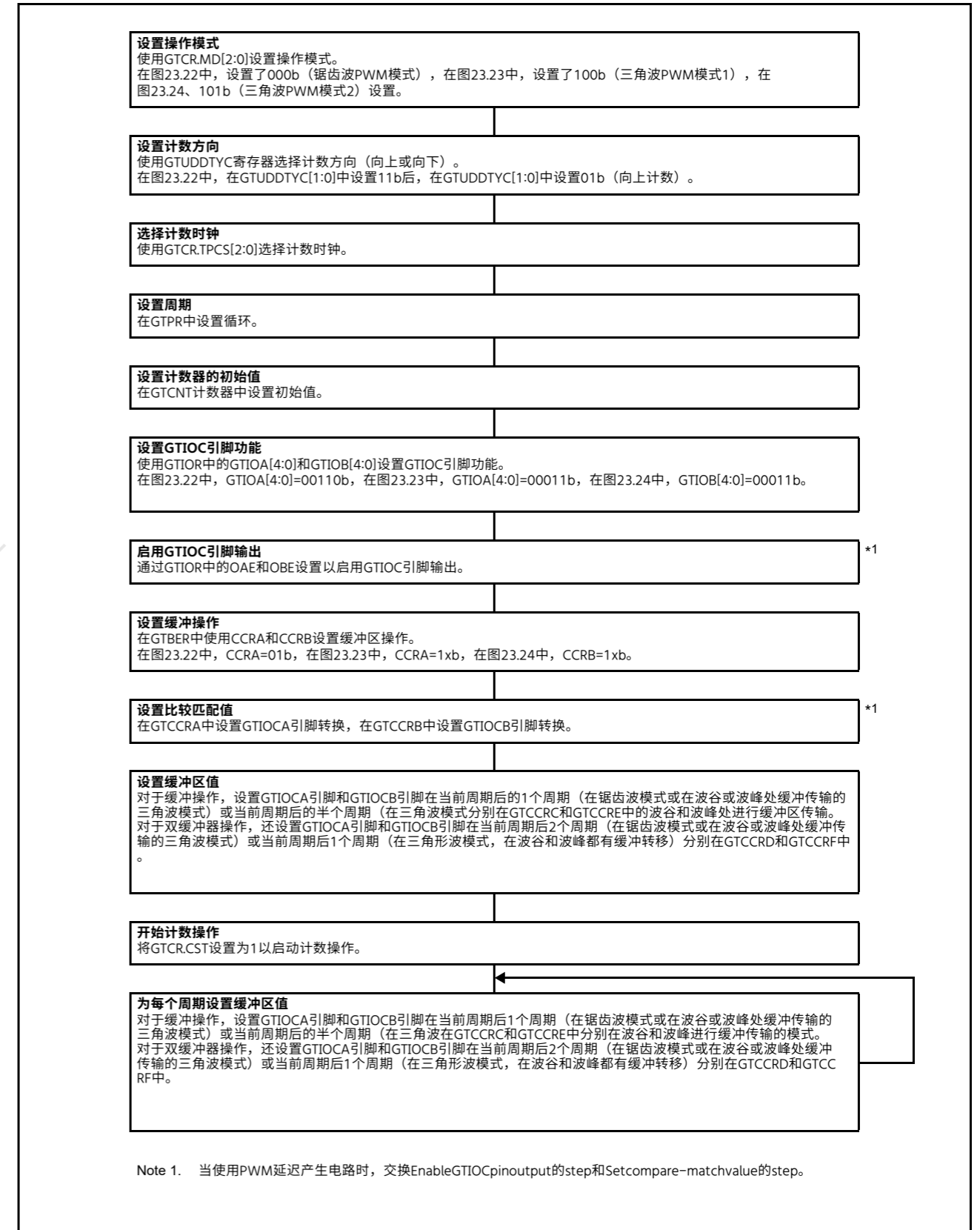
Figure 23.25 带输出比较的GTCRA和GTCCRB缓冲区操作设置示例
