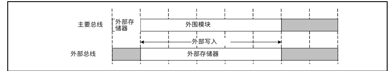
Figure 15.41 使用写入缓冲区功能时的示例操作
