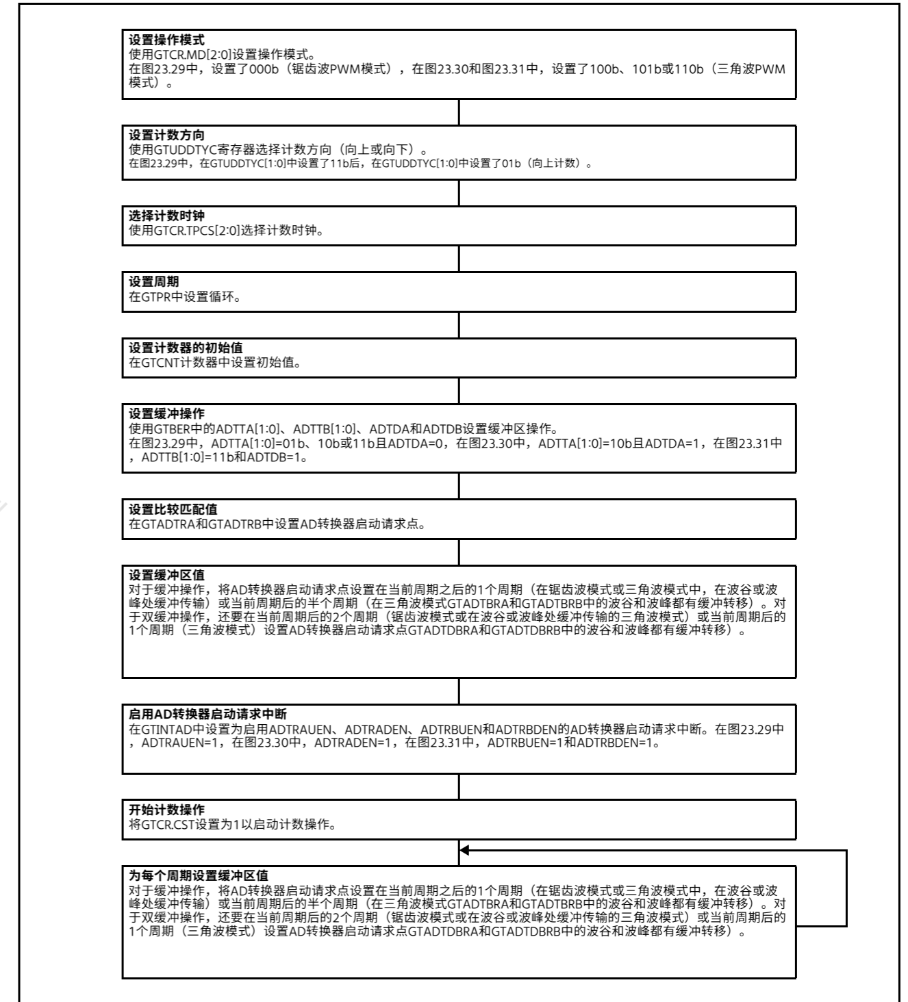
Figure 23.32 GTADTRA和GTADTRB缓冲操作的示例设置
