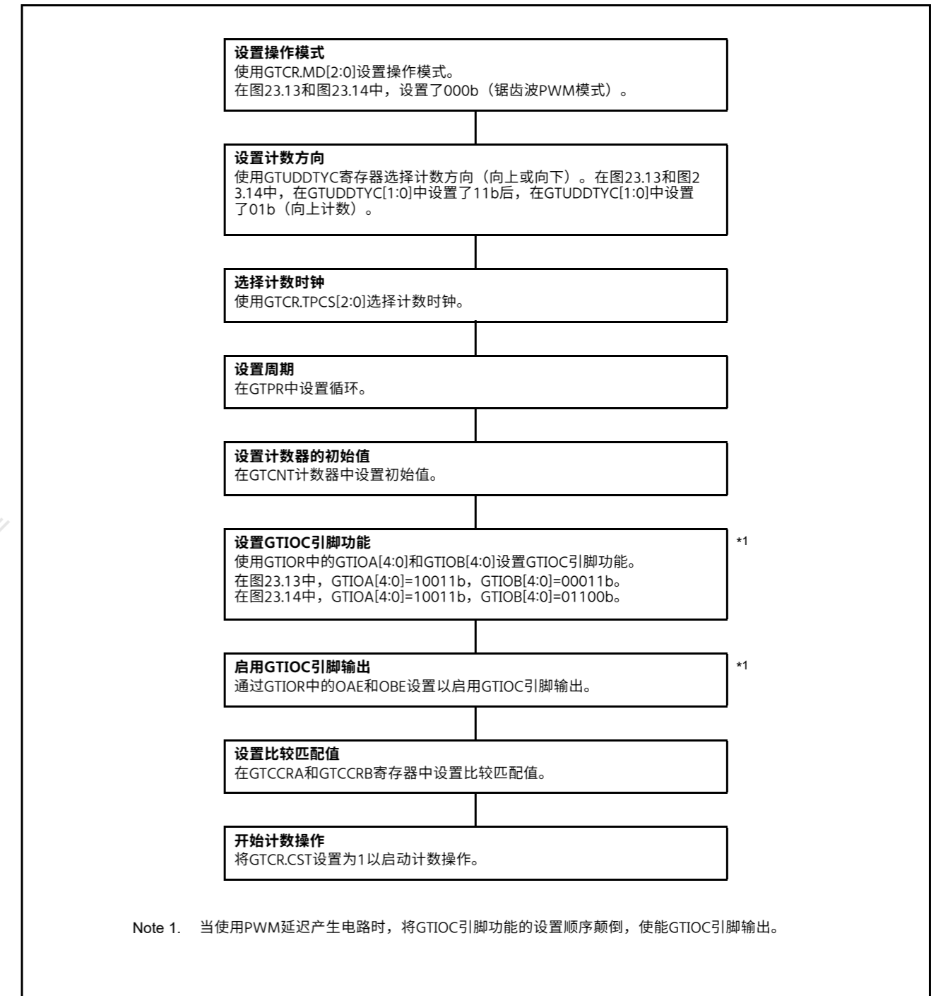
Figure 23.15 切换输出操作的示例设置
